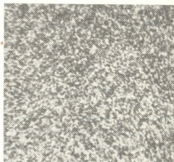
Рис. 4. Распределение алюминия в образце (Al—14 ат.%)
