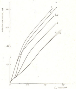
Рис. 1. Влияние продолжительности электролиза с растворимыми анодами марки М1 (кр. 1—5) и «Осч» (кр. 6, 7) на катодную поляризацию меди при следующих количествах пропущенного электричества (Ач/л): 1—0; 2—5; 3—20; 4—40; 5—200; 6—20. Кривая 7 соответствует случаю 6 после добавления 10^{-3} г/л Cl^-
