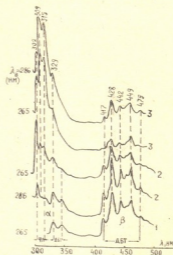
Рис. 2. Спектры флуоресценции ( \alpha ) и фосфоресценции ( \beta ) бинарной смеси дибензтиофен (ДБТ)+флуорен (ФЛ) в н-гексане при 77°К и \lambda_{\text{в}}^{\text{эф}}=286 и 265 нм соответственно. S_{\text{ДБТ}}:S_{\text{ФЛ}}=10:1 (1), 2:1 (2) и 1:5 (3). Спектрофлуориметр „Флуорикорд“
