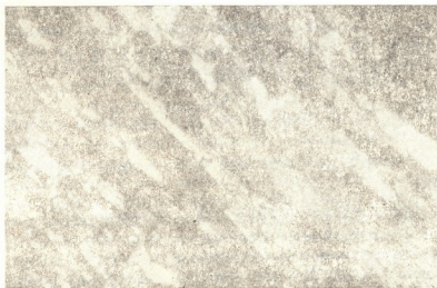
Рис. 4. Параллельное расположение шестоватых зерен кварца в ориентированно-зернистом известняке (ув. 60 \times , Ni+)
