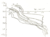
Рис. 3. Анодная поляризация железа, никеля и сплавов железа с никелем в смеси растворов хлористого натрия и едкого натрия при рН 12. Обозначения те же, что на рис. 1
