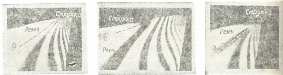
Рис. 1. Картины полос (изохромы) в режущей части инструмента при строгании: а — врезание, б — установившееся резание, в — выход
