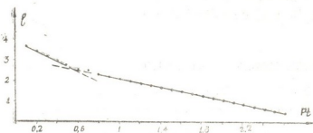
Рис. 2. Решение системы уравнений \dot{n}_1 = -pn_1 - qn_1n_2 , \dot{n}_2 = -pn_2 - qn_1n_2 , имеющее вид n = n_1 + n_2 = a\varphi(t) \exp(-pt) , где a = n_{10} - n_{20} ; \varphi = 1 + 2/(b \exp \psi - 1) ; \psi = c[1 - \exp(-pt)] ; b = n_{10}/n_{20} ; c = aq/p ; n_{10} и n_{20} — начальные значения n_1 и n_2 . На оси ординат l = \ln(n/a) + \ln[1 + 2/(b-1)] . Рисунок построен для случая b = 1.1 , c = 5 , когда начальная часть графика, не являясь прямой, выглядит как прямая, что создает впечатление наложения двух экспонент, подобных найденным в эксперименте [5]
