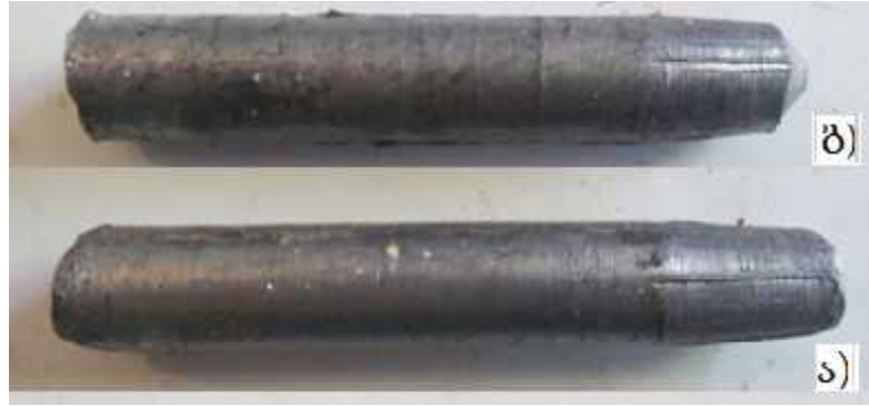
ნახ.33. დეფორმირებული ნიმუშები: ა - D20; ბ - D24
