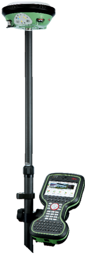
სურ. 5. Leica Nova TS60 მოდელის პზო როვერი
