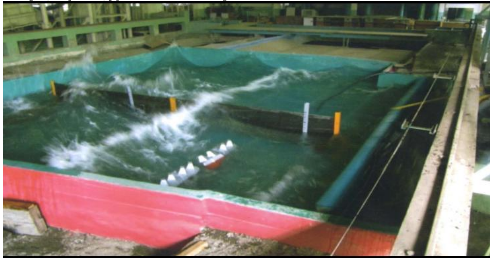
სურ.1. ახალი ტიპის მოტივტივე ტალღაშემარბილებელი ჰიდროტექნიკური ნაგებობის კონსტრუქციის მოდელის გამოცდა
