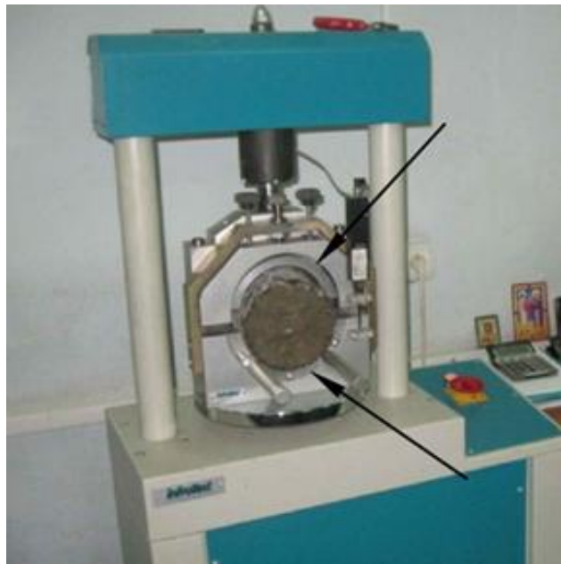
ნახ. 6. ასფალტბეტონის ფენებს შორის შეჭიდულობის ძალის გასაზომი მოწყობილობა
