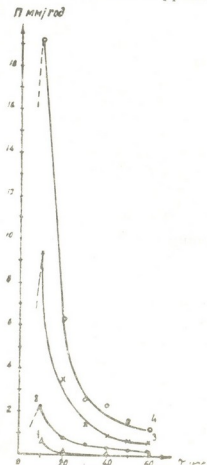
Рис. 4. Кинетика процесса коррозии хрома и его сплавов с РЗМ в 80%-ном растворе HNO_3 при 100°C: 1—хром; 2—хром+0,83% иттрия; 3—хром+1,48% лантана; 4—хром+2,83% иттрия
