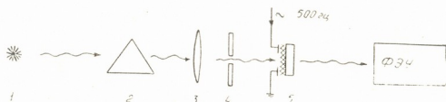
Рис. 1. Оптическая блок-схема установки для измерения эффекта Франца—Келдыша: 1—точечная лампа накаливания; 2—спектрометр ИКС-21; 3—объектив; 4—щель; 5—исследуемый образец, помещенный в конденсатор
