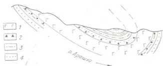
Рис. 1. Разрез р. Арашха: 1—габбро-диабаз; 2—контактовая зона; 3—алеволиты; 4—песчаники
