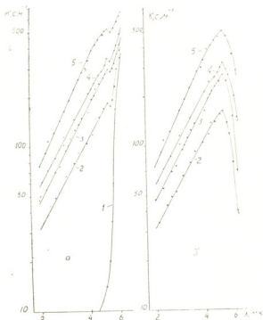
Рис. 2. Зависимость коэффициента поглощения от длины волны при комнатной температуре: N_d - N_a \cdot 10^{17} , \text{см}^{-3} : 2—1,7; 3—7,8; 4—9,3; 5—12
