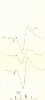
Рис. 2. Спектры ЭПР пропил- (а), гексил- (б) и нонилтиоцианата (в), облученных дозой 1,5 Мрад
