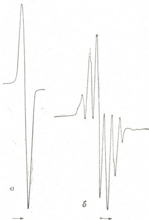
Рис. 1. Спектры ЭПР \gamma -облученных тиолов при 77°К: а—этантиол, 15 мрад; б—октадекантиол, 15 мрад
