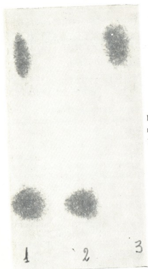
Рис. 1. Хроматограмма суммы алкалоидов в тонком слое в системе эфир, насыщенный водой: 1—сумма алкалоидов, выделенная из эфедры рослой; 2—эфедрин; 3—псевдоэфедрин
