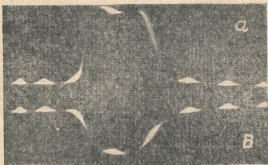
Рис. 3. Осциллограммы: а) импульса тока, проходящего через диод-излучатель, в) соответствующего импульса света. Цена каждой метки 0,2 мксек
