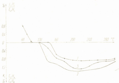
Рис. 1. Зависимость последовательности вымывания и коэффициентов разделения в системе этилен—пропан от температуры нагрева колонки, заполненной барийсодержащим цеолитом. Номера кривых соответствуют номерам образцов
