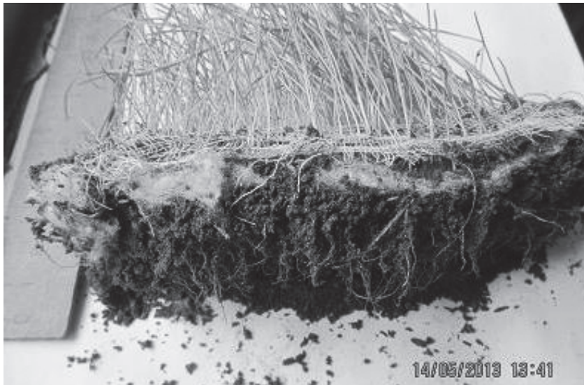
სურათი 6. გეოხალიჩა „Eroecomat“-ის ფრაგმენტის გვერდხედი (ჭრილი)
