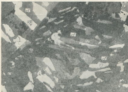
ნაბ. 2. სფალერიტის ქალკობირიტით ჩანაცვლების გრაფიკული სტრუქტურა, გამოვლინებული სამეფო წყლის ორთქლის ზემოქმედებით. სფალერიტის (sl.) პოლისინთეტურად დამრჩობლივ კრისტალთა აგრეგატში ცალკეული მონთ-კრისტალის ფარგლებში ჩანს ერთნაირად ამოკმული ქალკობირიტის (cp.) ფირფიტისებრი სხეულები; სფალერიტი აქაც ქალკობირიტის ემულსიურ გამოწყოფებს შეიცავს; შლ. № 43, X350, ნიკოლები.
