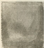
Рис. 1. Катодное отложение металлического марганца. В результате проникновения кислого, содержащего MnO_2 , анодного раствора в катодит, в правом углу началось обратное растворение.
