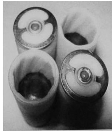
Рис. 1. Патроны травматического действия 18x45 мм с нарезками внутри гильз
