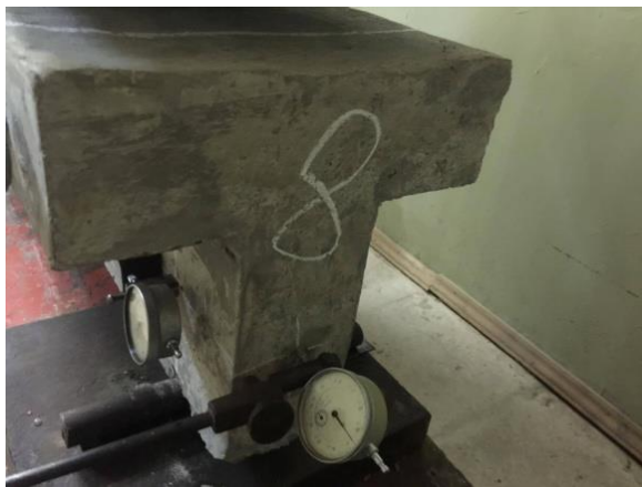
ნახ.20. რკინაბეტონის შედგენილი კვების კოჭი
