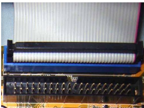
სურ. 4. 27 სისტემური პლატის ფრაგმენტი ATA სლოტებით
