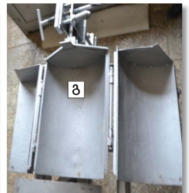
სურ. 7. უძრავი კამერა (ა) და მოძრავი კამერა: ბ) დახურულ მდგომარეობაში, გ) გახსნილ მდგომარეობაში.
