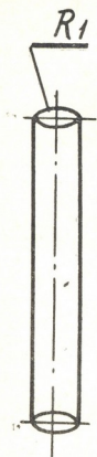
Рис. 1. Стадии изготовления длиномерной цилиндрической заготовки; а — цилиндрический пруток из гомополимера с высоким значением коэффициента показателя преломления ( n_2 ) и радиусом R_1 .
