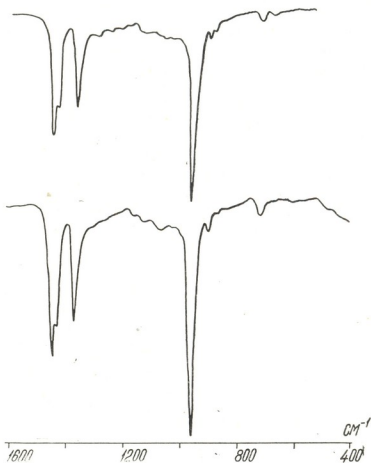
Рис. 4. Фрагменты ИК-спектров олигомеров пиперидена, полученных при использовании в качестве катализатора: раствора комплекса хлористого алюминия с ацетоном в ацетоне (а), раствора комплекса хлористого алюминия с этилацетатом в этилацетате (б).
