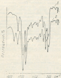
Рис. 1. ИК-спектры масел бензольных экстрактов термопластификатов, полученных 1 — при 250°C; 2 — при 370°C
