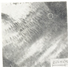
Рис. 4. Электронная микрофотография межеферолитной области в пленке полимера II
