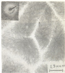
Рис. 3. Электронная микрофотография пленки полимера II, отлитой на стеклянную подложку и отожженной при 180—200°
