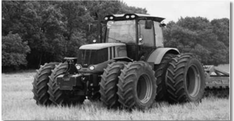
სურ.3. აგრეგატი შეწყვილებული თვლიანი ტრაქტორით.
