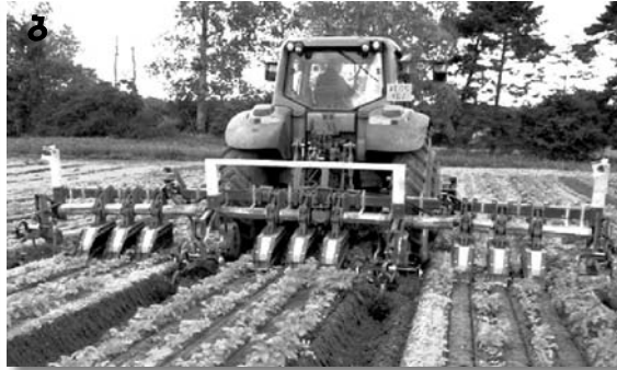
სურ. 6. ბაზო-კვალზე ნიადაგის რიგთაშორის გაფხვიერება: ა) ბაზოებზე, ბ) ბაზო-კვალზე.
