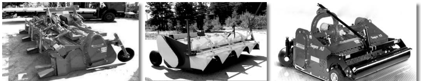
სურ. 3. ბაზო-კვალის წარმომქმნელი კომბინირებული მანქანები აქტიური სამუშაო ორგანოებით კომბინირებული მანქანები პასიური სამუშაო ორგანოებით
