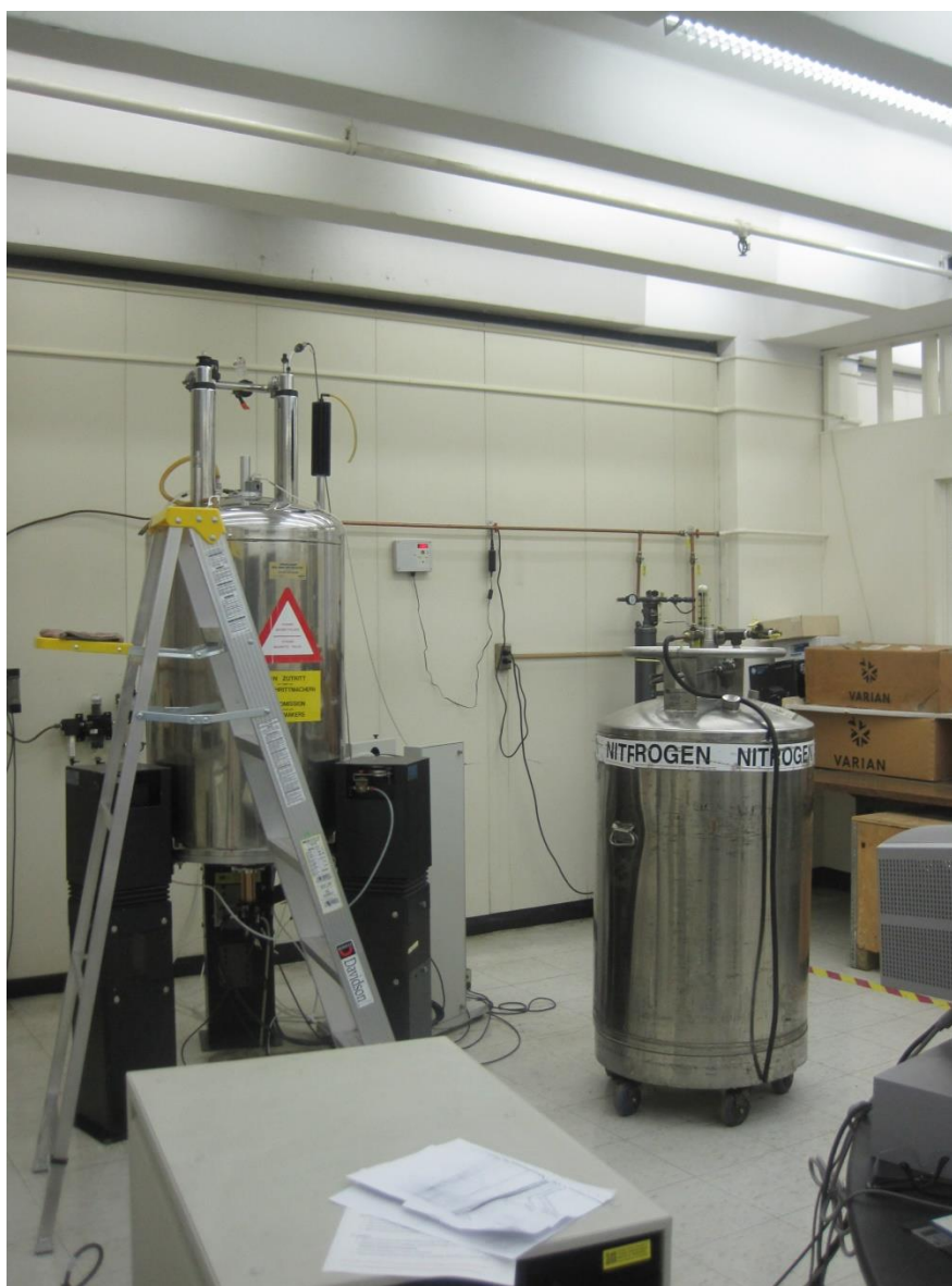
სურ. 3. ბირთვულ-მაგნიტური რეზონანსული სპექტროსკოპი Aligent Mercury 300
