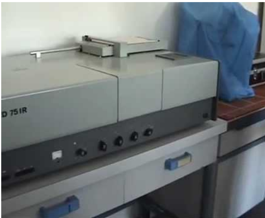
სურათი 1. ინფრაწითელი სპექტრომეტრი Specord 75
