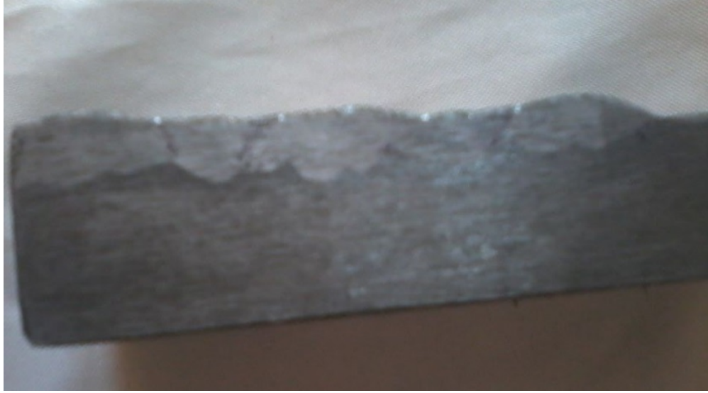
Рис.10. Количество трещин и их размеры при однослойной наплавке стали.
