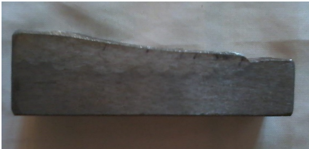
Рис.11. Количество трещин и их размеры при двухслойной наплавке стали.
