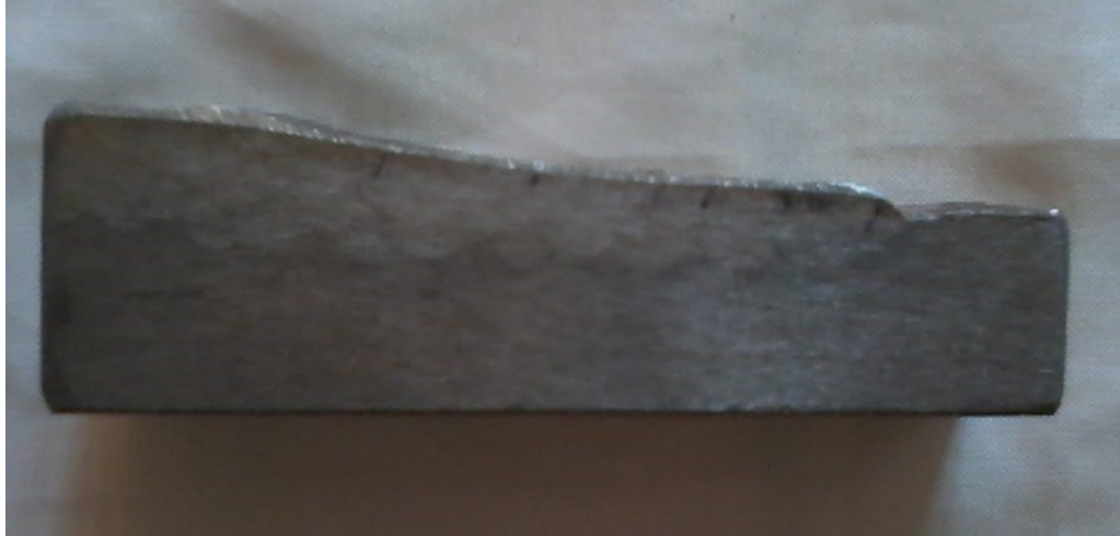
ნახ.11. ბზარების რაოდენობა და მათი ზომები ორფენიან დადუღებულ ფოლადში
