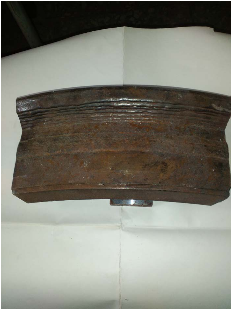
Рис.1.5. Наплавленная колесная пара (а) и фрагмент, вырезанный из колесной пары.
