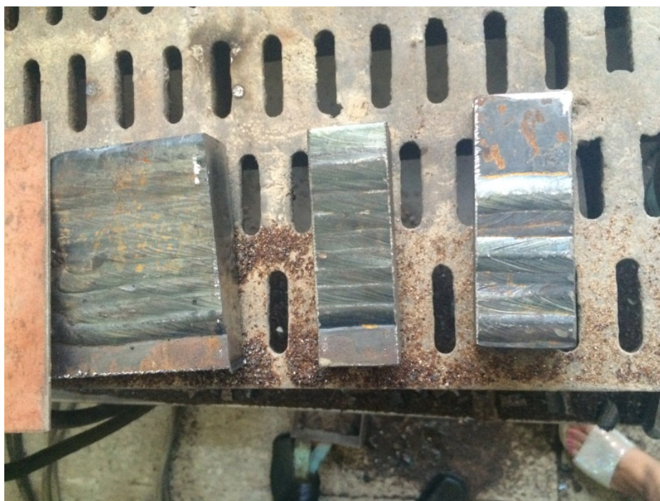
Рис.4.4. Вырезанные образцы, наплавленные в один и два слоя
