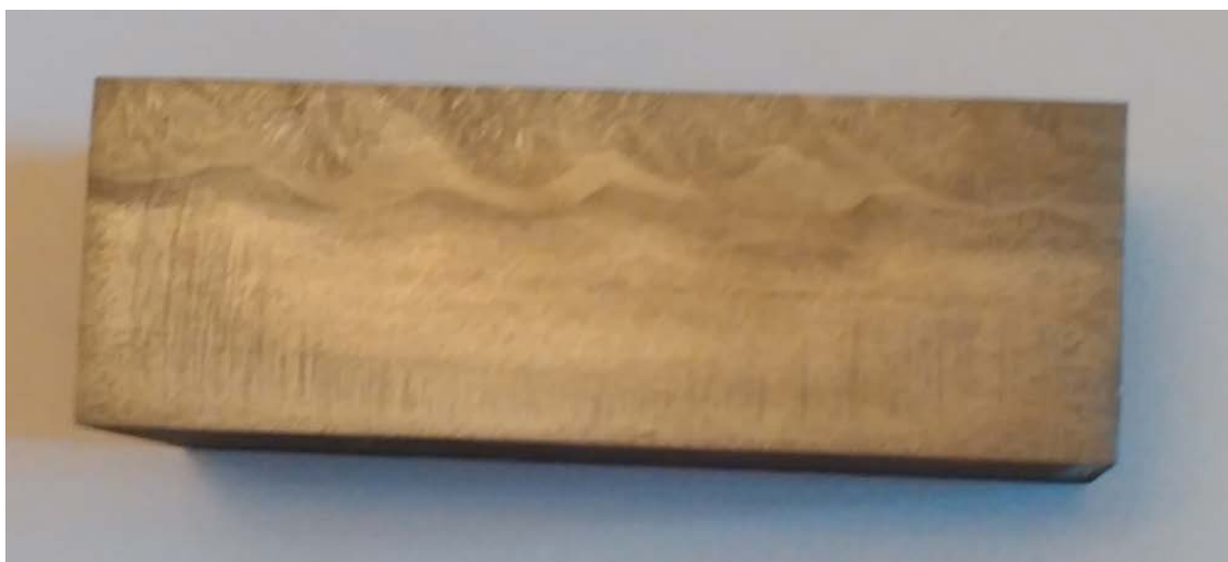
Рис.4.10 Образец без трещин после пластической деформации
