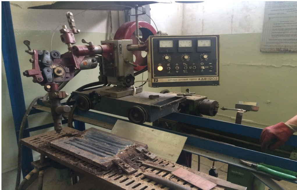
Рис.4.1 Стенд для наплавки образцов
