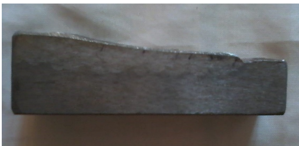
Рис.4.6. Количество трещин и их размеры при двухслойной наплавке стали.
