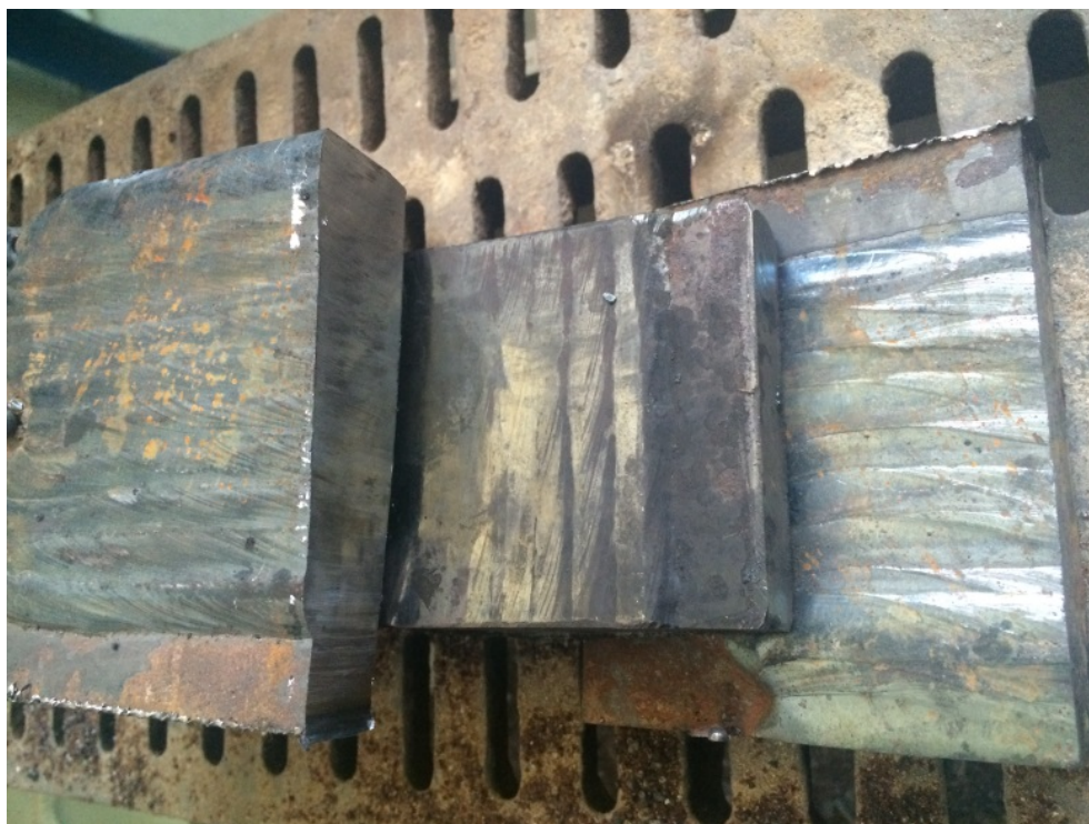
Рис.4.9. Образец, обработанный молотом
