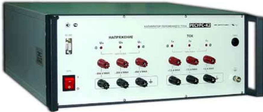
ნახ.2.2.Pecopc-K2M ტიპის ცვლადი დენის კალიბრატორი.
