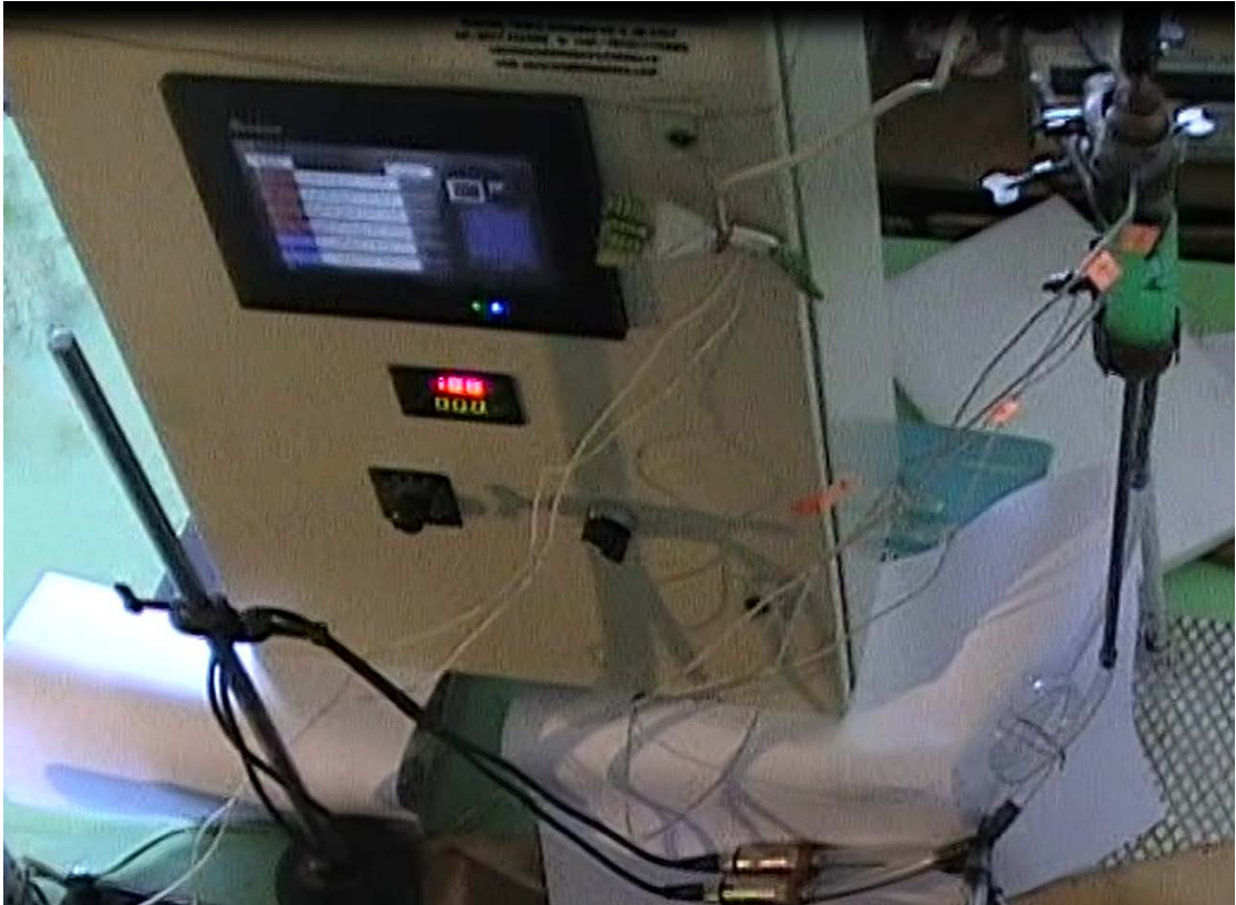
სურათი 3. მოდიფიცირებული თბურამპრავიანი მემბრანული ტუმბოს ექსპერიმენტალური მოდელის საკვლევი სტენდი
