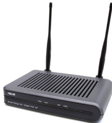
ნახ. 9. წვდომის წერტილი უსადენო ლოკალურ ქსელს აკავშირებს მავთულიან ქსელებთან
