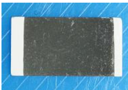
ნახ. 48. La_5Bi_3 -ის სიტალის ფუძემშრეზე დაფენილი თხელი ფირი (ფირის სისქე - 0,9 მკმ)
