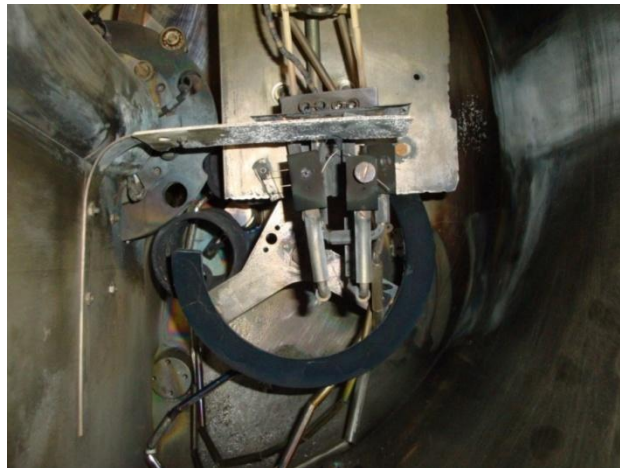
ნახ. 17. ვაკუუმურ-თერმული აორთქლების მეთოდით ომური კონტაქტების შესაქმნელი დანადგარის ვაკუუმური კამერა
