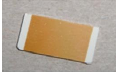
ნახ. 30. Tm_2S_3 -ის ფირები (ფუძემწრე სიტალი, ფირის სისქე-1.8 მკმ)
