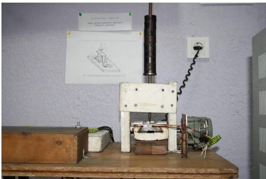
ნახ. 77. სრული გახევის მეთოდით ფირების ფარდობითი მექანიკური სიმტკიცის შესასწავლი დანადგარი
