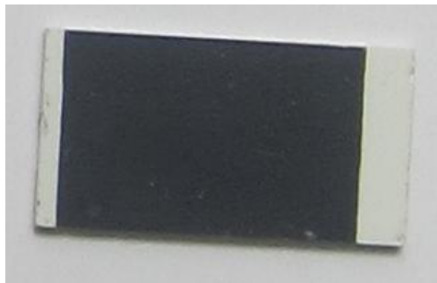
ნახ. 52. LaBi-ის თხელი ფირის სურათი (სურათი გადაღებულია ვაკუუმური კამერიდან გამოღებისთანავე)
