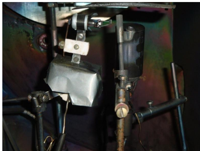
ნახ. 35. სილიციუმის ელექტრონების ნაკადით ასაორთქლებელი დანადგარის კამერის მოწყობილობა
