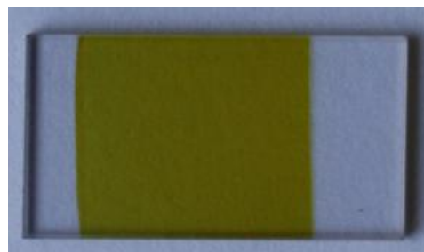
ნახ. 44. ლეიკოსაფრონზე დისკრეტული ვაკუუმურ-თერმული აორთქლების მეთოდით დაფენილი TmSe-ის თხელი ფირი (ფირის სისქე 0,9მკმ)
