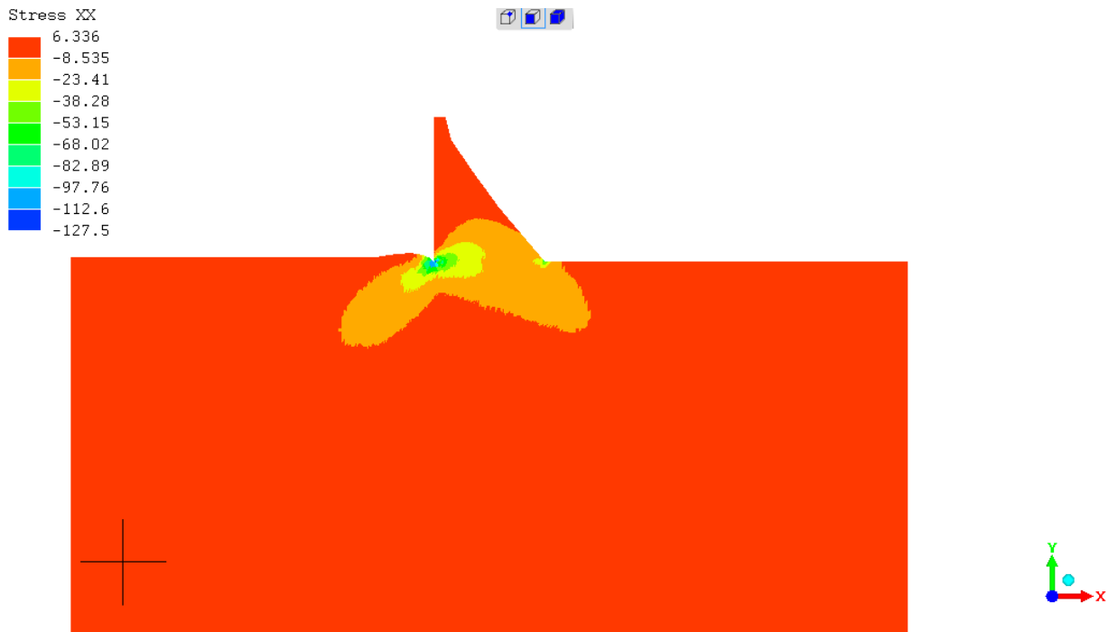
ნახ. 4.10: ჰორიზონტალური ნორმალური \sigma_x ძაბვების იზოუბნები.
