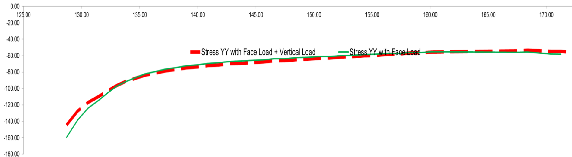
ნახ. 4.35: \sigma_y დაბეჭედი 10-10 კვეთში (7154 – 8220). წითელი და წვევტილი ტეხილი ხაზი - \sigma_y დაბეჭედი მეორე შემთხვევისათვის – ყველა ძალის ერთობლივი მოქმედება; მწვანე ტეხილი ხაზი - \sigma_y დაბეჭედი პირველი შემთხვევისათვის – მხოლოდ საკუთარი წონა პიდროსტატიკური დაწნევა სადაწნეო წახნაგზე.
