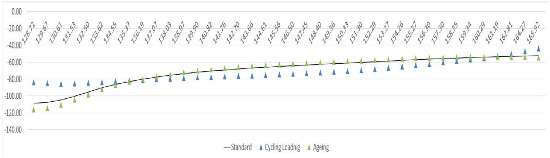
ნახ. 4.45: ვერტიკალური ნორმალური \sigma_y ძაბვების ეპიურები მე-9 კვეთში როდესაც სისტემაზე მოქმედებს კაშხლის საკუთარი წონა, ჰიდროსტატიკური წნევა სადაწნო წახნაგზე და ვერტიკალური ჰიდროსტატიკური დაწნევა წყალსაცავის ფსკერზე ( უწყვეტი ხაზი – საპროექტო ვარიანტი, ცისფერი სამკუთხედი – ციკლური დატვირთვების გათვალისწინებით, მწვანე სამკუთხედი – ასაკის გათვალისწინებით).
