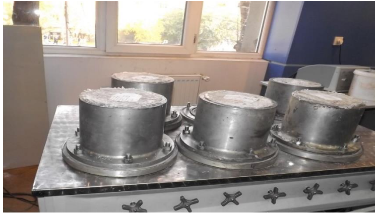
სურათი №4.1 ჰიდროტექნიკური ბეტონის ცილინდრული ნიმუშები წყალშეუღწევადობის სტენდზე
