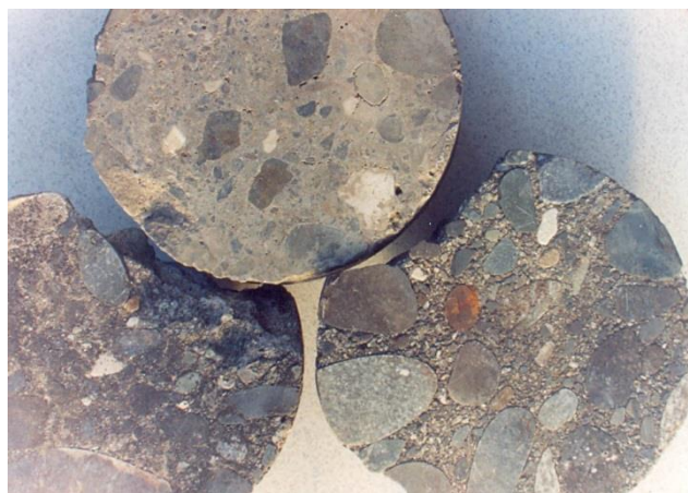
სურათი №1.1 ენგურჰესის თაღოვანი კაშხლიდან ამოღებული ბეტონის ფუძეთა ცილინდრული ფორმის ნიმუშები
