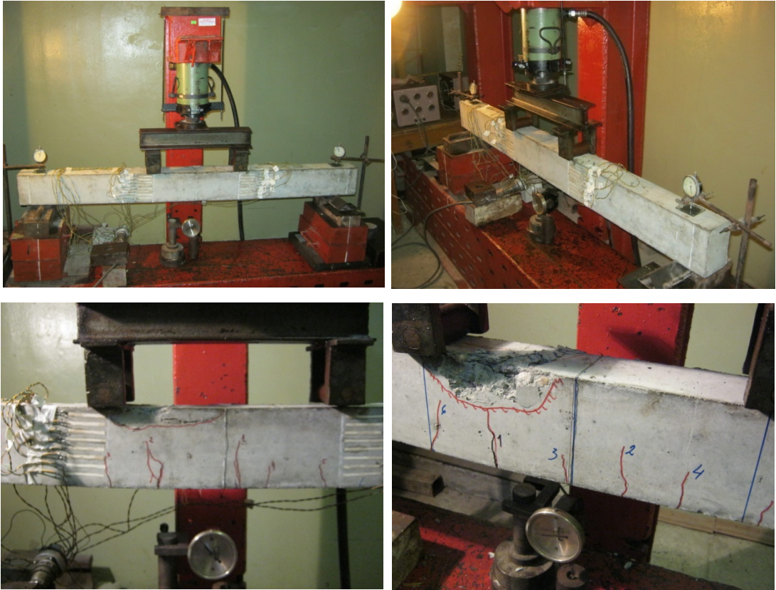
ნახ. 10 რკინაბეტონის კოჭების გამოცდა
