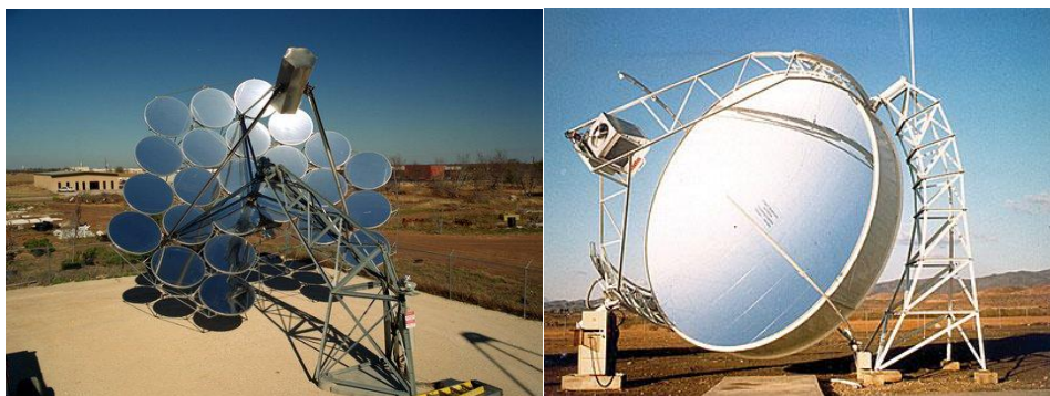
ნახ.14 გადაჭიმულ გარსიანი პარაბოლოიდური თეფშიანი კონცენტრატორი.
