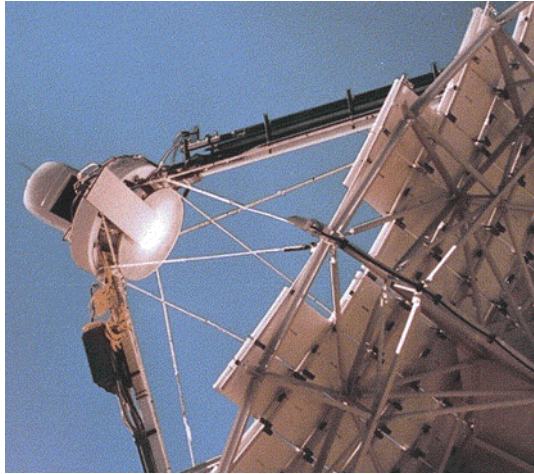
ნახ.46. სტირლინგის 25 კვტ–იანი თბური ძრავი მზის ენერჯის გარდაქმნის სისტემით, სანდიას ნაციონალური ლაბორატორია.
