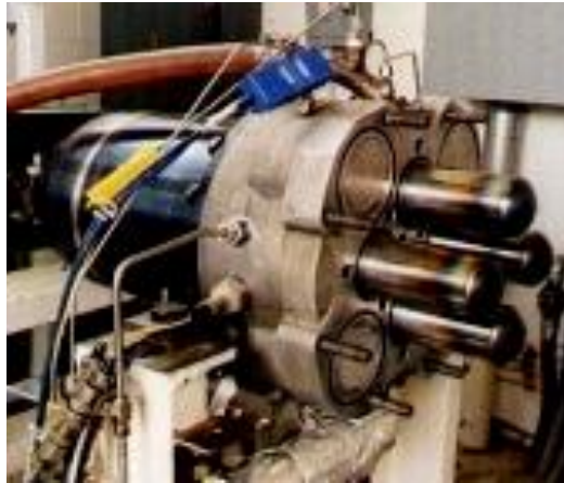
ნახ.41. ცილინდრების კვადრატული განლაგების მქონე სტირლინგის ძრავი.
