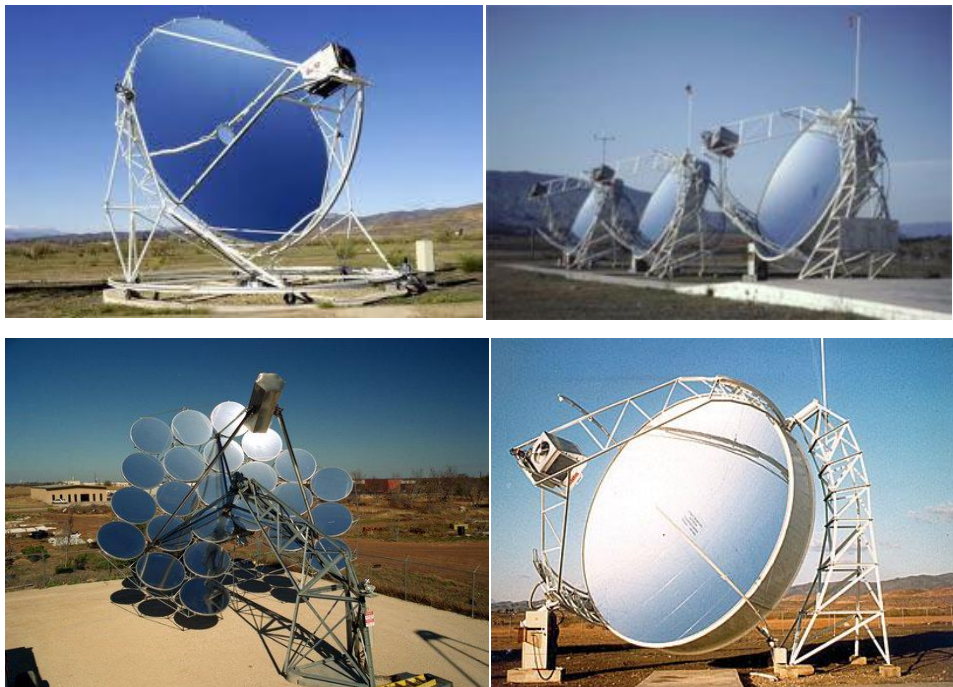
ნახ.37. გადაჭიმულ გარსიანი პარაბოლოიდური თეფშიანი კონცენტრატორი.
