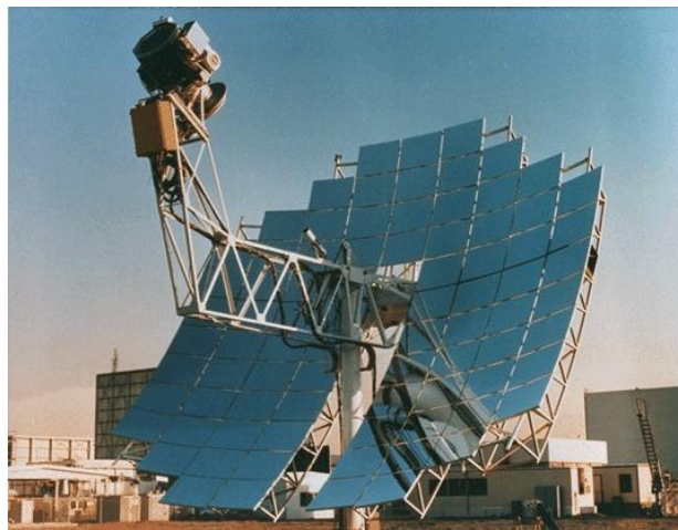
ნახ.42. მაკდონალ დუგლასი, სამხრეთ კალიფორნია, ედისონი 25 კვტ-იანი სტირლინგის თევზიანი სისტემა.
