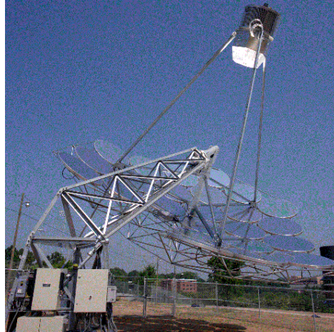
ნახ.45. კუმინის 7,5 კვტ-იანი თავისუფალ დგუშიანი სტირლინგის ძრავი თეფშიანი კონცენტრატორით.
