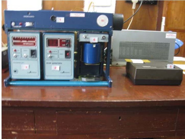
ნახ. 2.6 ტრანსფორმატორის ზეთში მექანიკური მინარევების რაოდენობის დასადგენი ფოტომეტრული ანალიზატორი AO3-101. 1- ოპტიკური ბლოკი; 2 – დოზატორის ბლოკი; 3 – ანალიზატორი; 4 – სარეველა; 5 – საბეჭდი მოწყობილობა.
