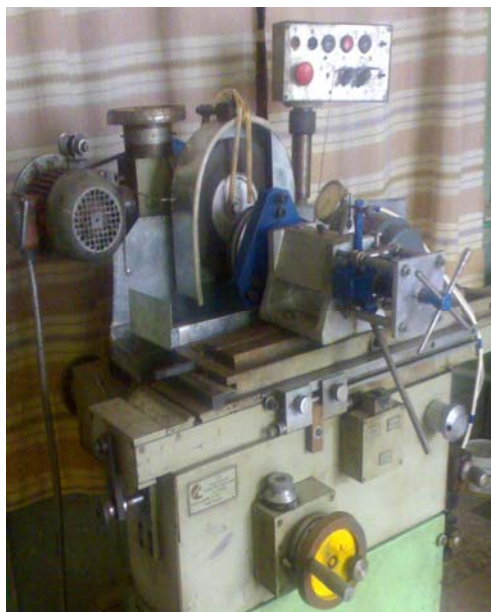
ნახ. 13 ა- დაბალტემპერატურული პრეციზიული ხეხვის სქემა : 1- სახეხი რგოლი; 2- კასეტა დეტალებით. ბ-დტხ-ს ლაბორატორიული მოწყობილობა;
