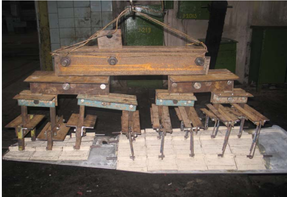
სურ.71 ბერკეტული სისტემის კონსტრუქცია, ფრთაზე აეროდინამიკური დატვირთვის იმიტირებისათვის.
