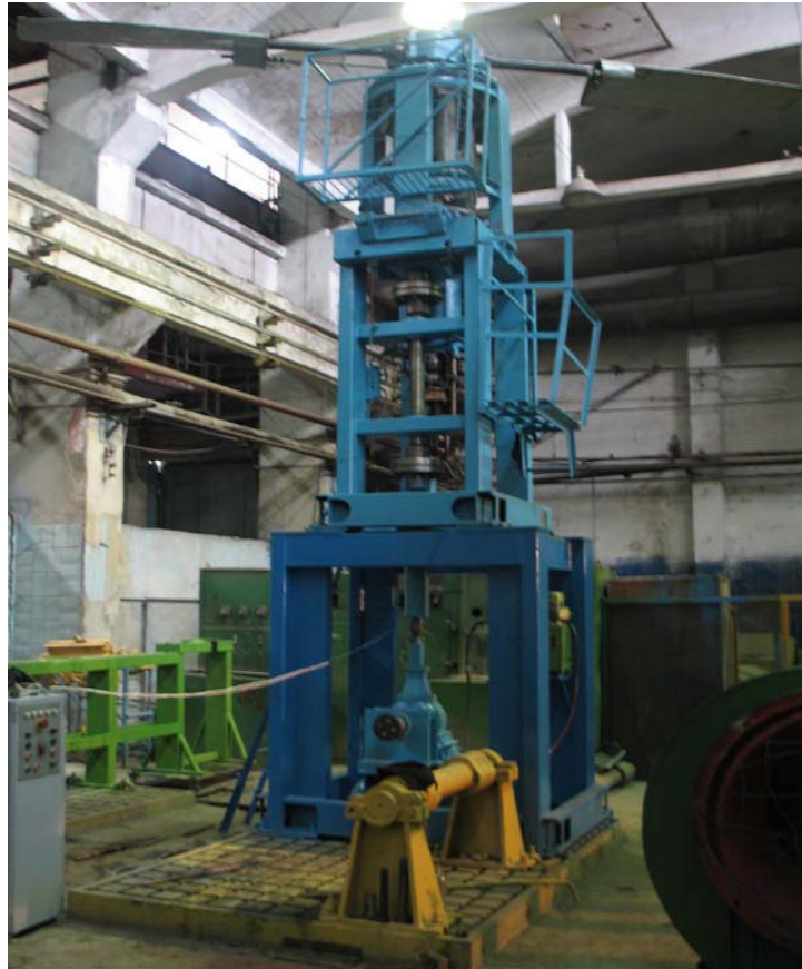
სურ.45 ცვალებადი გეომეტრიის ხრახნის მოდერნიზირებული დინამიური გამოცდების სტენდი.
