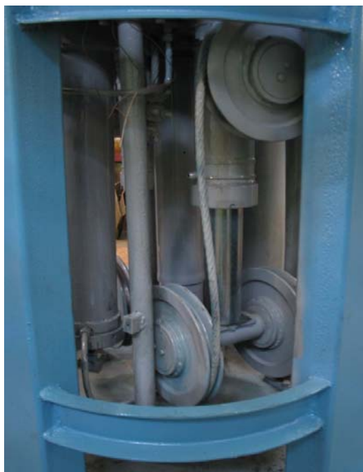
სურ.43 სტენდის მესამე ბლოკში ჩამონტაჟებული ცენტრიდანული ძალების კომპენსირების მექანიზმი
