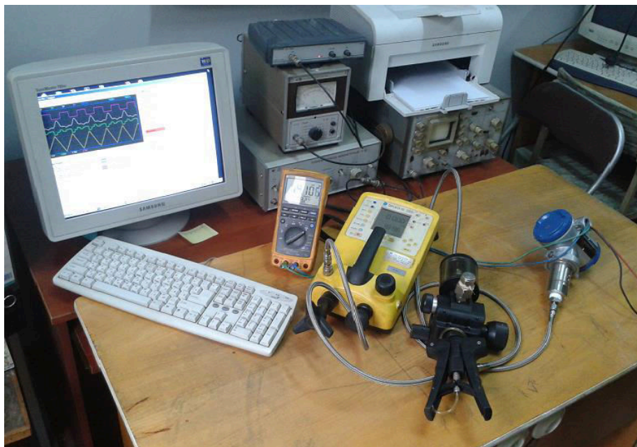
ნახ. 15. წნევის ტრანსმიტერის დაკალიბრება ლაბორატორიულ პირობებში
