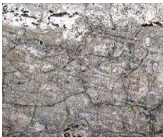
სურ.1.2. წვრილი ბზარების ქსელი ბეტონის ნიმუშის ზედაპირზე
